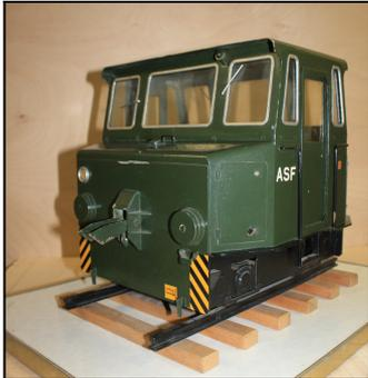
Es handelt sich hierbei um ein Präsentationsmodell des Akku-Schleppfahrzeug (BR EL16) der Deutschen Reichsbahn, die vom Lokomotivhersteller LEW Hennigsdorf (LEW = Lokomotivbau und Elektrotechnische Werke) mit einer Stückzahl von 514 Triebfahrzeugen in den Jahren 1966 bis 1990 in unterschiedlichen Varianten produziert wurden.
