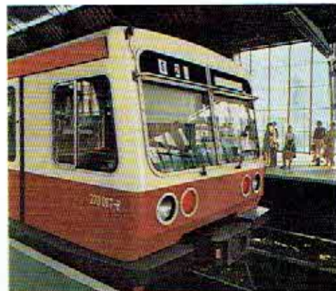
Bild 8 LEW-Elektrotriebzug BR 270 mit Choppersteuerung und Nutz/Widerstandsbremse
