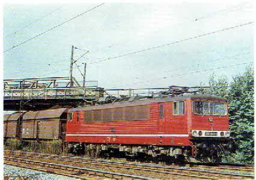
Bild 4 Leistungsstärkste Lokomotive der Deutschen Reichsbahn: LEW-Elektrolokomotive der Baureihe 250 mit einer Leistung von 5400 kW
