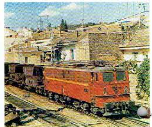
Bild 4 Leistungsstärkste Lokomotive der Deutschen Reichsbahn: LEW-Elektrolokomotive der Baureihe 250 mit einer Leistung von 5400 kW
